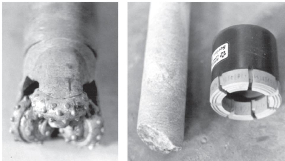
شکل ۴-۲-۵- مته غلطکی سه مخروطی (سمت چپ). مته مغزه گیر سنگ و رسوبات مغزه سنگ (سمت راست)
